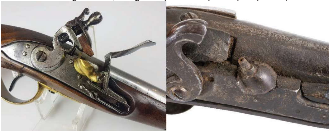
Fig. 6. Pistol M1798 cu sistemul de dare a focului original (stânga) și modificat în cel cu capse de percuție (dreapta).
